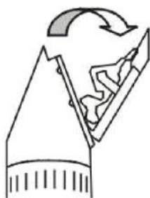
Desmontagem da lâmina
