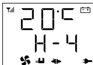
tryb uruchamiania, tryb ręczny (oznaczony literą H)
