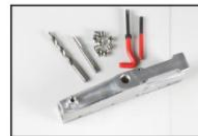
6. Le fil est réparé et prêt à l'emploi.
