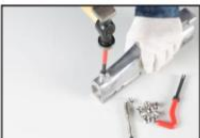
5. Breek de adapterbevestiging af met een puntbreekgereedschap.
