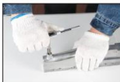
2. Taraudez le trou percé à l'aide d'un taraud.
