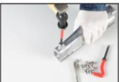
5. Con una herramienta de punta de destornillador, rompa el soporte del adaptador.
