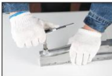
2. Наріжте різьбу в просвердленому отворі за допомогою мітчика.
