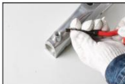
3. Τοποθετήστε το τυλιγμένο ένθετο στον εφαρμοστή.
