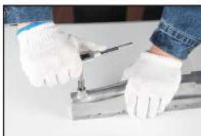
2. Нарежьте резьбу в просверленном отверстии с помощью метчика.
