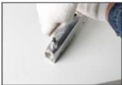
4. Zašroubujte adaptér do závitového otvoru.
