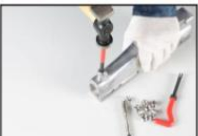
5. Используя инструмент для отламывания наконечника, отломите крепление адаптера.
