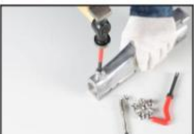
5. Izmantojot uzgaļa nolaušanas instrumentu, nolauziet adaptera stiprinājumu.
