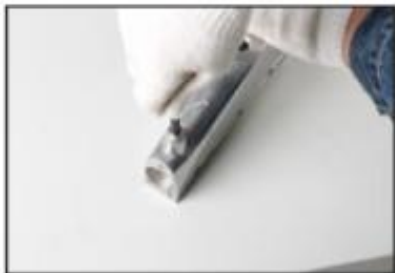
4. Zaskrutkujte adaptér do závitového otvoru.
