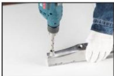
1. Išgręžkite pažeistą sriegį tinkamo dydžio grąžtu.
