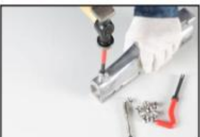
5. Χρησιμοποιώντας ένα εργαλείο σπασίματος μύτης, σπάστε τη βάση του προσαρμογέα.
