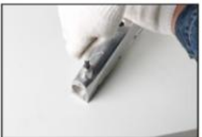
4. Schroef de adapter in het schroefdraadgat.
