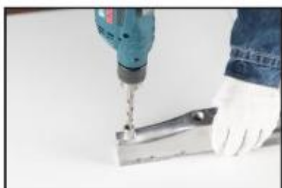
1. Boor de beschadigde draad uit met een boortje van de juiste maat.
