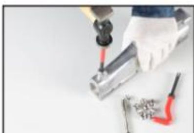
5. À l'aide d'un outil de rupture de pointe, cassez le support de l'adaptateur.
