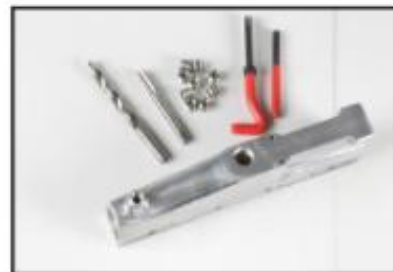
6. Gwint jest naprawiony i gotowy do użycia.
