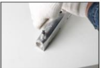
4. Avvitare l'adattatore nel foro filettato.
