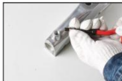
3. Introduceți insertul rulat în aplicator.
