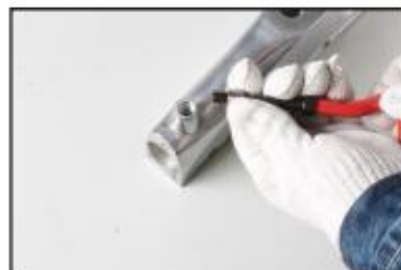
3. Insérez l'insert roulé dans l'applicateur.
