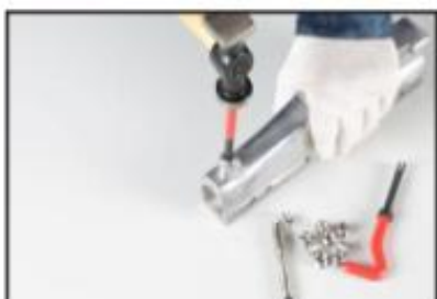
5. Utilizzando uno strumento per rompere la punta, rompere il supporto dell'adattatore.
