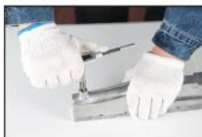
2. Filetați gaura perforată folosind un tarod.
