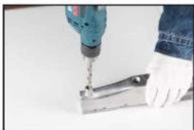
1. Îndepărtați filetul deteriorat cu un burghiu de dimensiunea corespunzătoare.
