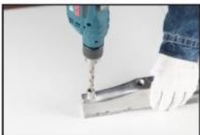
1. Poškodený závit vyvŕtajte vrtákom vhodnej veľkosti.
