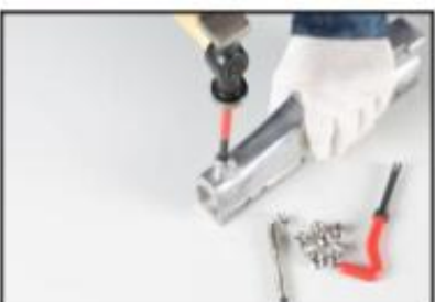
5. За допомогою інструмента для зламання наконечника відламайте кріплення адаптера.
