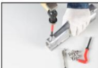
5. Izmantojot uzgaļa nolaušanas instrumentu, nolauziet adaptera stiprinājumu.
