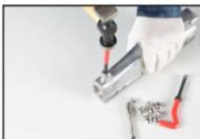
5. Pomocou nástroja na lámanie hrotu odlomte držiak adaptéra.
