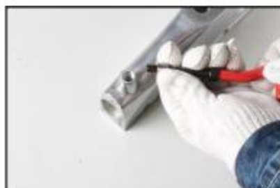
3. Plaats het opgerolde inzetstuk in de applicator.
