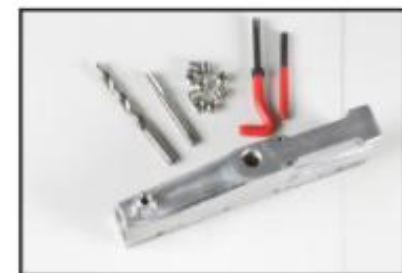
6. De draad is gerepareerd en klaar voor gebruik.
