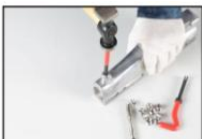
5. Folosind un instrument de rupere a vârfurilor, rupeți suportul adaptorului.
