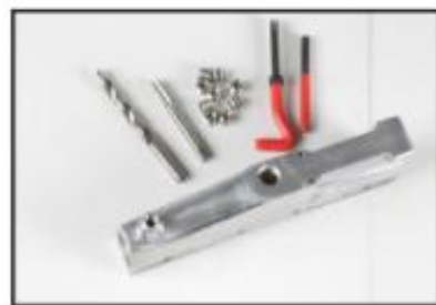
6. Niť je opravená a pripravená na použitie.
