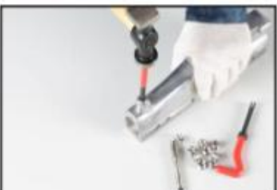
5. Antgalio laužimo įrankiu nulaužkite adapterio laikiklį.
