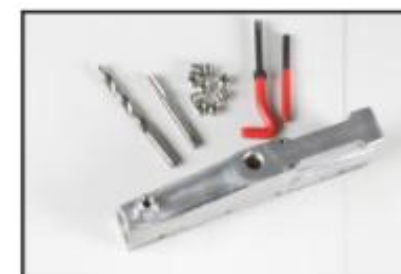
6. Filetul este reparat și gata de utilizare.
