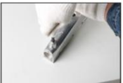
4. Atornille el adaptador en el orificio roscado.
