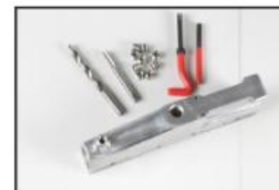
6. A rosca está reparada e pronta para uso.
