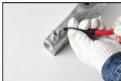
3. Inserte el inserto enrollado en el aplicador.
