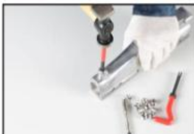
5. Używając narzędzia do łamania końcówek, odłam mocowanie adaptera.
