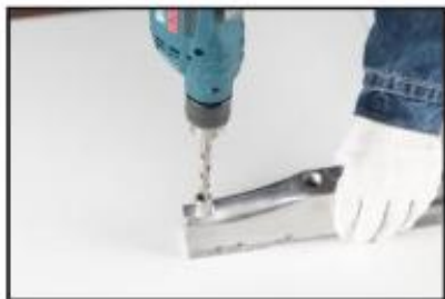
1. Висвердліть пошкоджену різьбу свердлом відповідного розміру.
