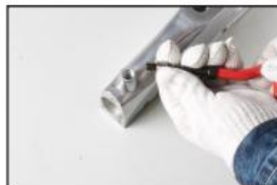
3. Τοποθετήστε το τυλιγμένο ένθετο στον εφαρμοστή.
