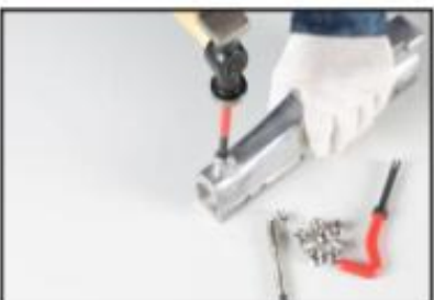
5. Pomocí nástroje na lámání hrotu odlomte držák adaptéru.
