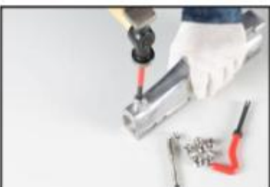
5. Usando uma ferramenta de quebra de ponta, quebre o suporte do adaptador.
