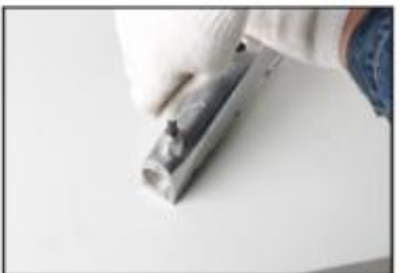
4. Rosqueie o adaptador no furo roscado.
