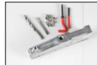
6. Резьба отремонтирована и готова к использованию.
