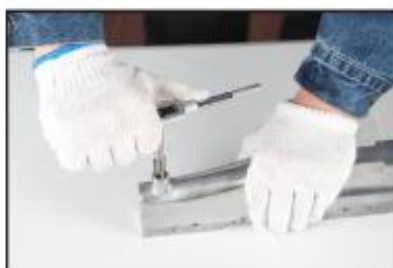
2. Išgręžtą skylę išsukite sriegtuvu.
