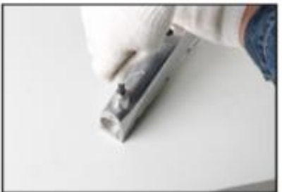
4. Ieskrūvējiet adapteri vītņotajā caurumā.
