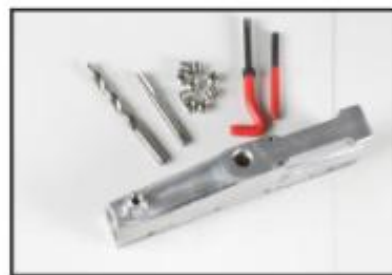
6. Niť je opravená a pripravená na použitie.
