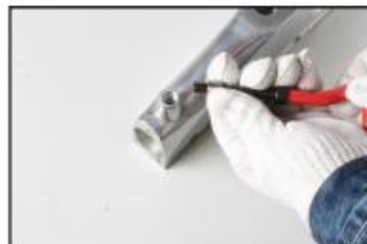
3. Вставьте скрученную вставку в аппликатор.
