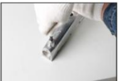
4. Vissez l'adaptateur dans le trou fileté.
