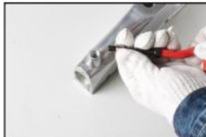
3. Włóż zwiniętą wkładkę do aplikatora.
