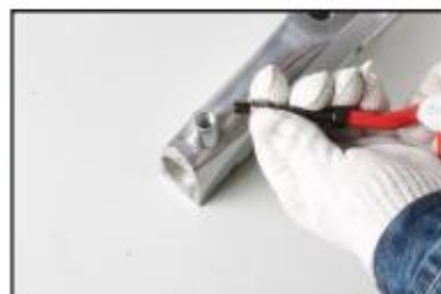
3. Plaats het opgerolde inzetstuk in de applicator.
