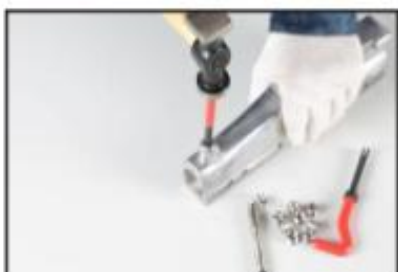
5. Folosind un instrument de rupere a vârfurilor, rupeți suportul adaptorului.
