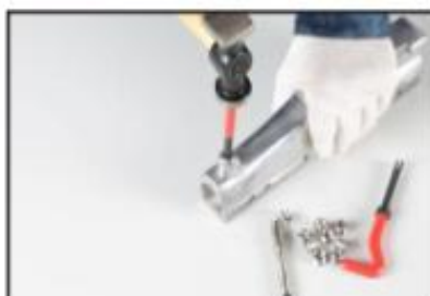
5. Utilizzando uno strumento per rompere la punta, rompere il supporto dell'adattatore.
