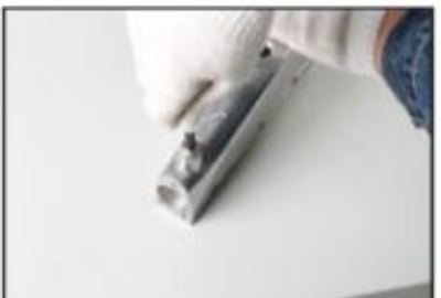
4. Вкрутите адаптер в резьбовое отверстие.
