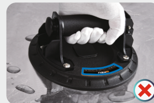
1. Powierzchnia płytek z wodą, olejem lub klejem
